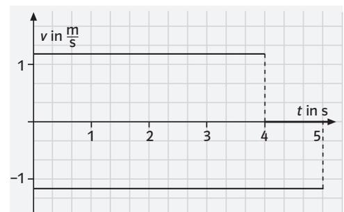
**A3** ○ Zur Untersuchung kann ein Diagramm gezeichnet oder die Geschwindigkeit für die einzelnen Intervalle berechnet werden. Es ergibt sich, dass eine gleichförmige Bewegung vorliegt.
