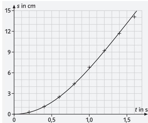
b) Zwischen  $t_0$  und  $t_5$  ist die Bewegung gleichmäßig beschleunigt, denn der Quotient  $s/t^2$  ist näherungsweise konstant. Zwischen  $t_5$  und  $t_8$  ist die Bewegung gleichförmig, denn der Graph ist linear.
