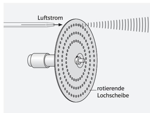
(S.159) Die Frequenz des entstehenden Tons ist abhängig von der Geschwindigkeit, mit der die Löcher die Düse passieren. Daher gehören also die Drehgeschwindigkeit der Scheibe, der Abstand der Lochreihe von der Drehachse (bzw. die Drehfrequenz der Scheibe) sowie die Anzahl der Löcher zu den Größen, die die Frequenz des Tones bestimmen.
