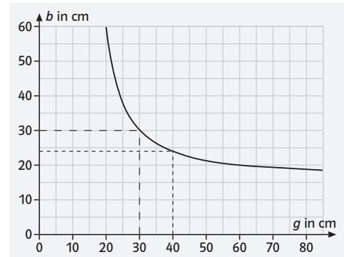
Durch Einsetzen eines Wertepaares von Gegenstands- und zugehöriger Bildweite kann man also die Brennweite der Linse berechnen:
