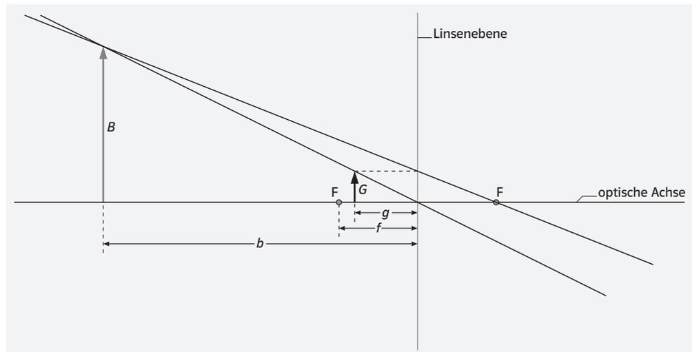
Die Konstruktion zeigt, dass ein virtuelles Bild entsteht, für das die Bildweite und die Bildgröße die Werte  $b = -60 \text{ cm}$  und  $B = 30 \text{ cm}$  annehmen.
