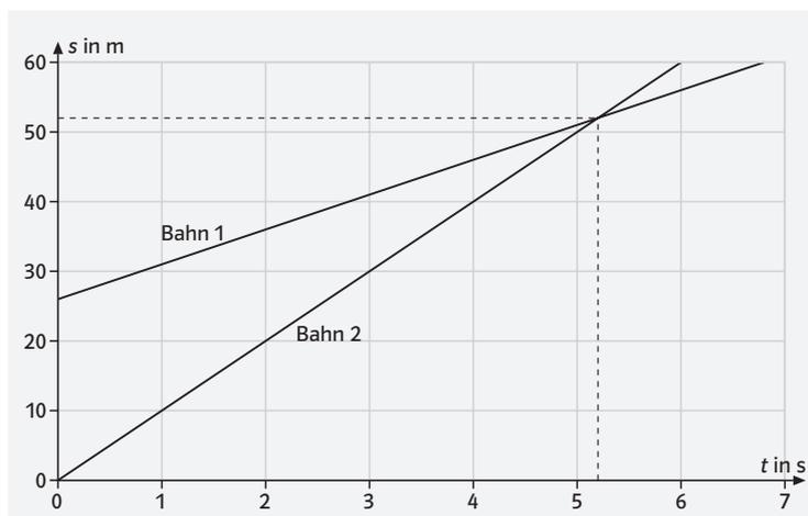
Der Schnittpunkt der beiden Graphen gibt an, nach welchem Weg sich die Spitzen der beiden Bahnen auf gleicher Höhe befinden und welche Zeit bis dahin vergangen ist. In Übereinstimmung mit den Ergebnissen aus Teilaufgabe c) erhält man  $t \approx 5,2 \text{ s}$ ,  $s_1 \approx 26 \text{ m}$  und  $s_2 \approx 52 \text{ m}$ .
