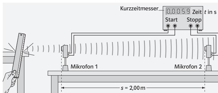
Aus dem Abstand  $\Delta s$  und der benötigten Zeit  $\Delta t$  lässt sich nach  $v = \Delta s/\Delta t$  die Schallgeschwindigkeit berechnen. In Luft ergibt sich ein Wert im Bereich von  $v = 340 \text{ m/s}$ .
