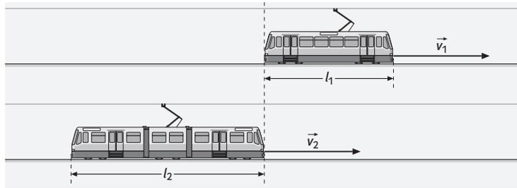
Die Zeit  $t$  ergibt sich aus der Länge der Bahn 1 (wenn Bahn 2 diesen Weg zurückgelegt hat, dann befinden sich die Spitzen beider Bahnen auf gleicher Höhe) und der Relativgeschwindigkeit zwischen den beiden Bahnen:
