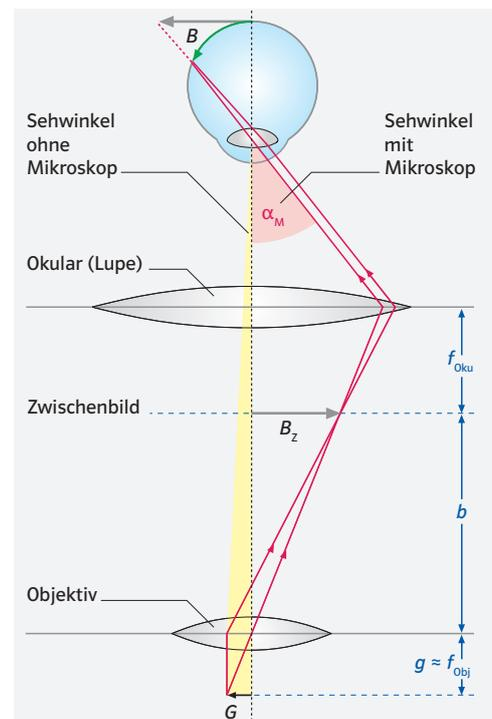
Diese Vergrößerung lässt sich aus den entsprechenden Sehwinkeln mit und ohne Lupe ermitteln. Bei der gewählten Anordnung können diese Sehwinkel durch die Quotienten  $G/f_{\text{Oku}}$  und  $G/f_{\text{Au}}$  ersetzt werden ( $f_{\text{Au}}$  bezeichnet die optimale Brennweite der Augenlinse; man geht davon aus, dass sie bei entspanntem Auge etwa 25 cm beträgt):
