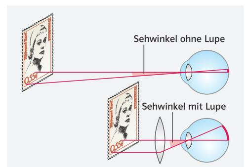
Netzhaut zusammenführen, so dass ein scharfer Bildpunkt entsteht. Das Bild ist kopfstehend und seitenvertauscht, es ist größer als das Bild, das ohne Lupe auf der Netzhaut entsteht. Der Sehwinkel, unter dem der Schriftzug erscheint, wird durch die Lupe vergrößert.
